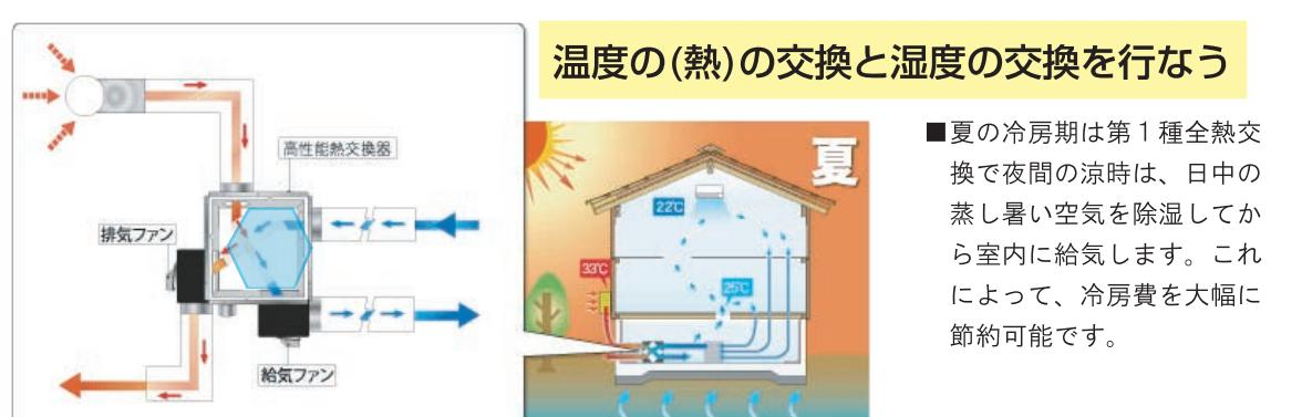
■夏の冷房期は第1種全熱交換で夜間の涼時は、日中の蒸し暑い空気を除湿してから室内に給気します。これによって、冷房費を大幅に節約可能です。
